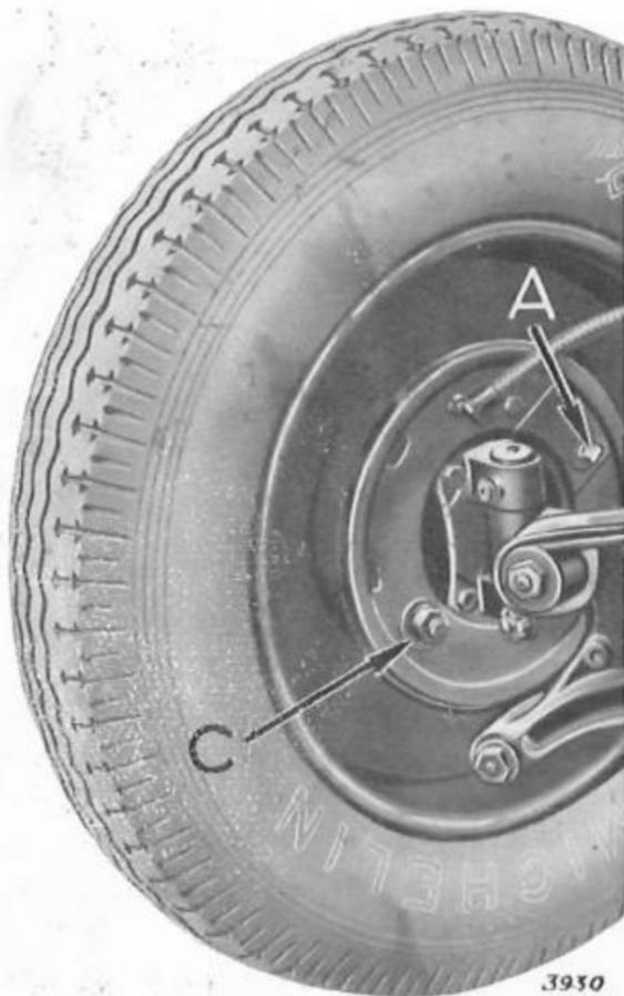
Fig. 21. — Réglage des freins avant.
