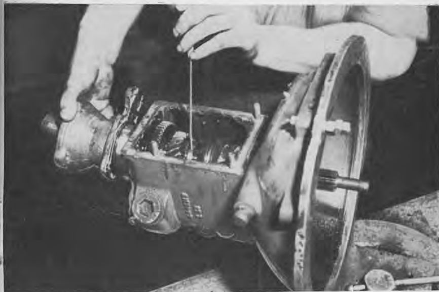
Fig. 5. — Dégagement du doigt de verrouillage du synchroniseur.
